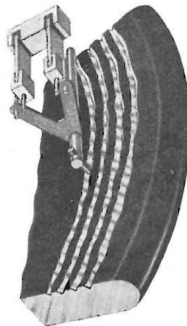
Fig. 6 - Incisione stereofonica secondo le fig. 5 cioè a 45° (x). Un canale ha una frequenza più bassa dell'altro.
