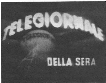
Fig. 2bis - Esempio di immagine con scarsa luminosità e poco contrastata causata da alterazione delle tensioni di alimentazione.
